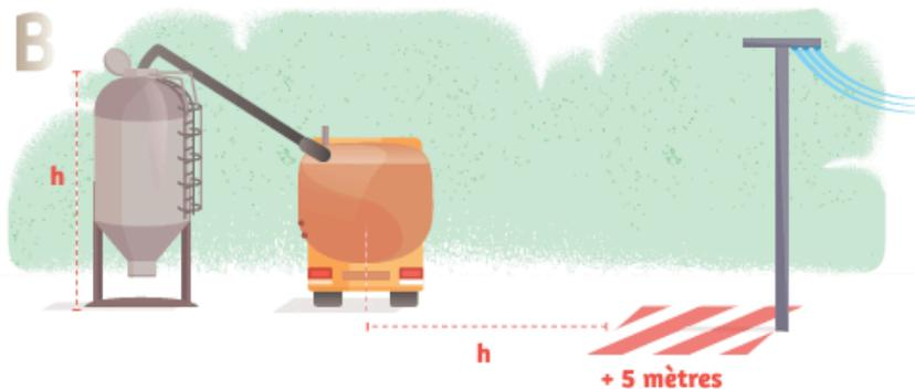
Lorsque les **distances horizontales** ci-dessus **ne peuvent être respectées**, la ligne électrique doit alors être à une hauteur minimale de **H + 5 m**
