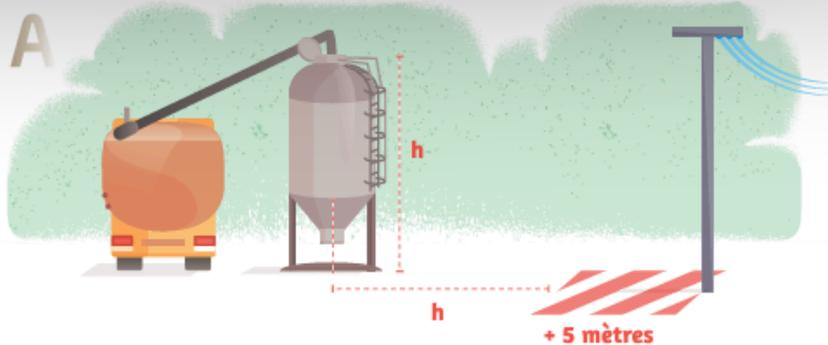
Si le **chemin d'accès** du véhicule de livraison est situé **entre la ligne électrique et le silo**, la distance entre la ligne électrique et le véhicule doit être au moins **égale à la hauteur du silo (H)** augmentée de 5 mètres
